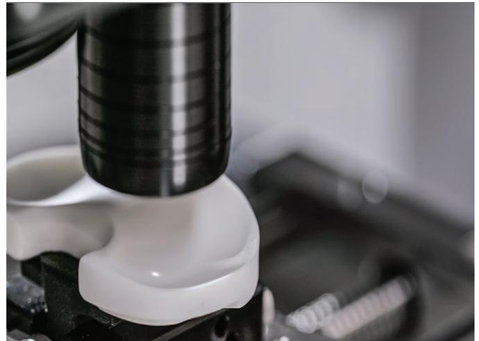
*ZEISS DotScan während eines optischen Scans*
