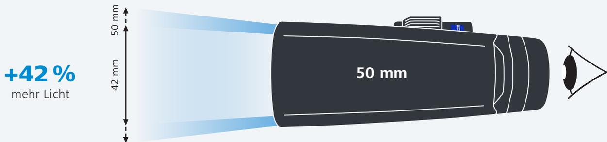
Die **größere Eintrittspupille** eines 50-mm-Objektivs sammelt 42 % mehr Licht als ein 42-mm-Objektiv\*
